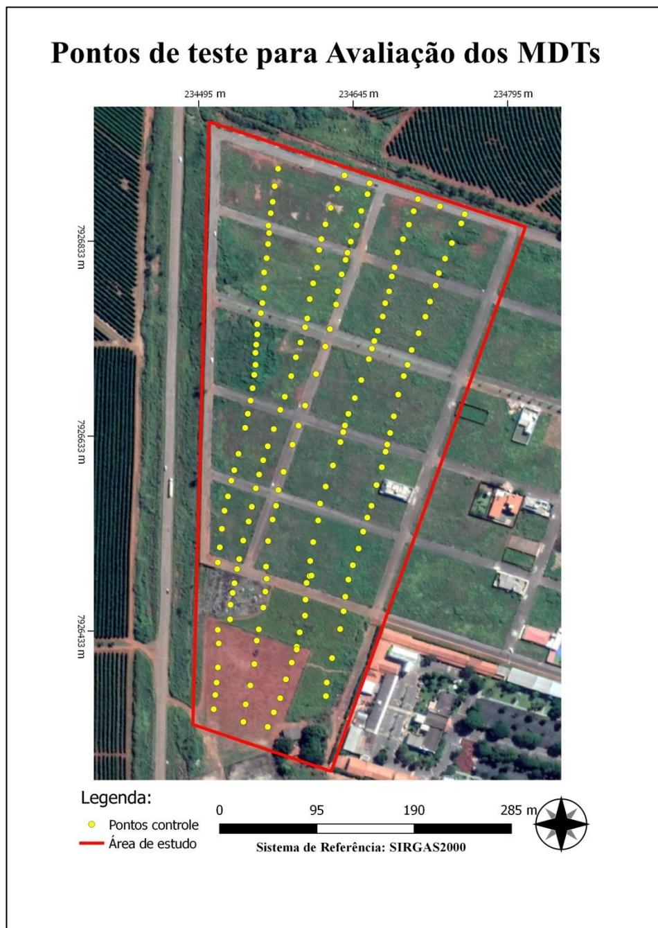
Os valores de desvio padrão das coordenadas dos pontos testes possuem também precisão de poucos milímetros, ficando todos os pontos com desvio padrão abaixo de 1 cm para as três coordenadas (N, E e h).
