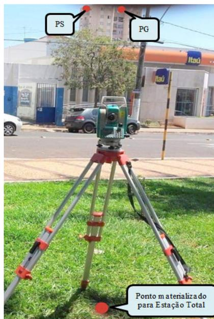
Figura 8- Localização do ponto estático da estação total e prismas.
