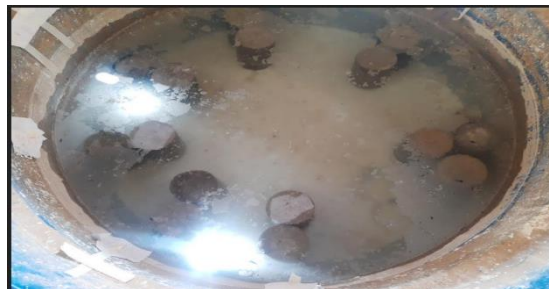
Figura 15 – cura por submersão sobre hidróxido de cálcio
