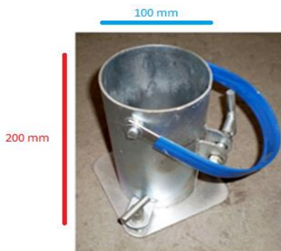
Figura 3 – Molde para corpo de prova de concreto
