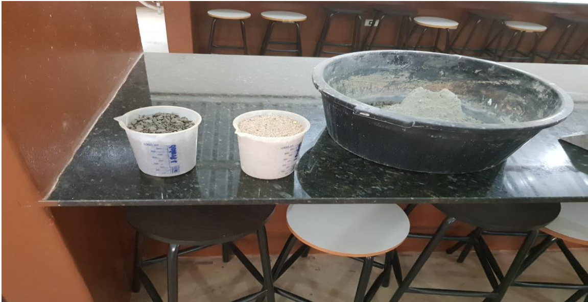
Figura 4 - Mistura dos componentes do concreto
