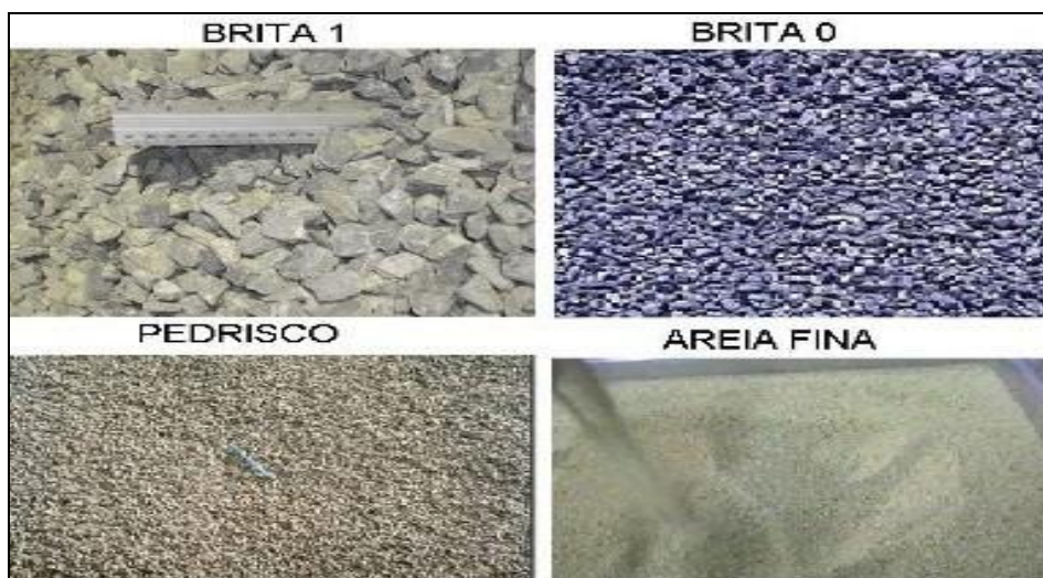
Figura 1 - Características morfológicas de agregados do concreto
