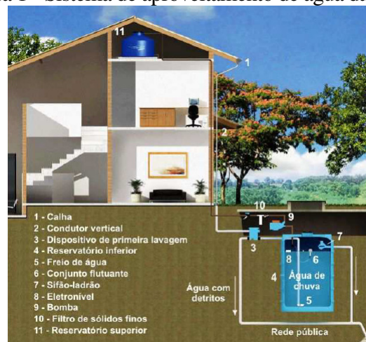
Figura 1 - Sistema de aproveitamento de água da chuva
